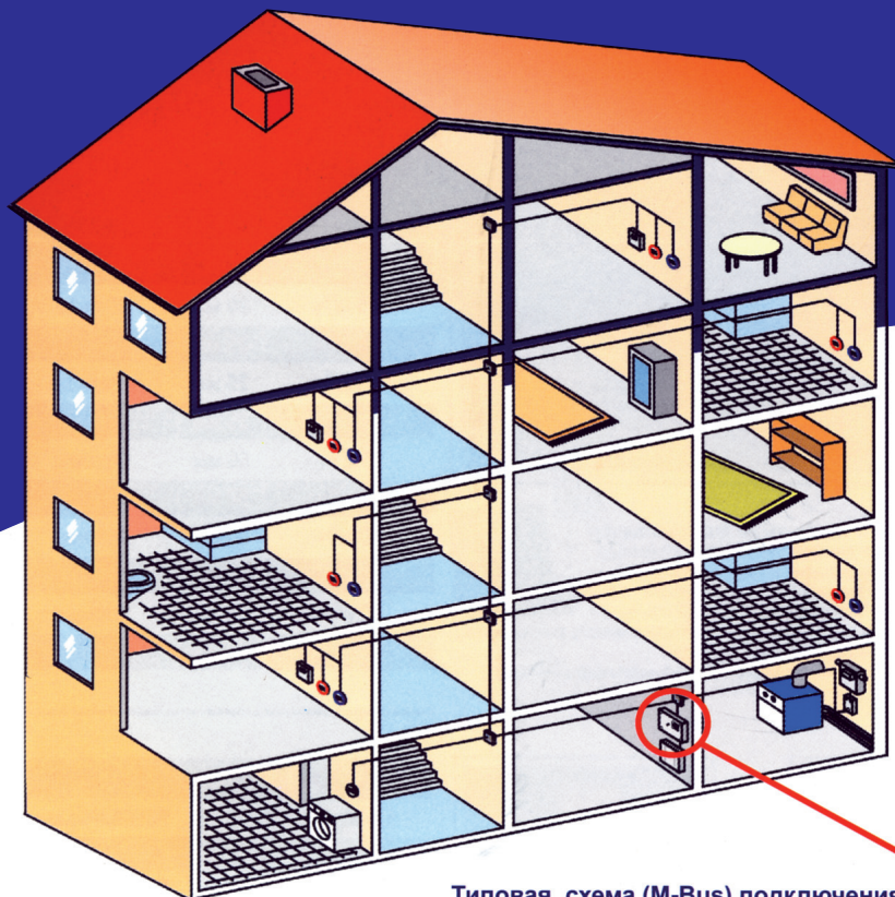
Типовая схема (M-Bus) подключения приборов учёта в стандартном многоквартирном доме
